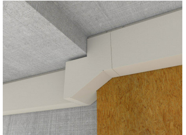
Deckenkanal mit Umfassung
